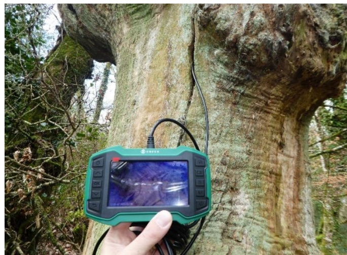
Notre caméra endoscopique, ici introduite dans la fissure d'un vieux tronc
