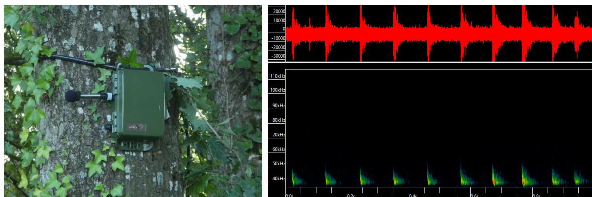
L'enregistreur SM4 Full Spectrum et un exemple de signal enregistré (Pipistrelle de Kuhl)
