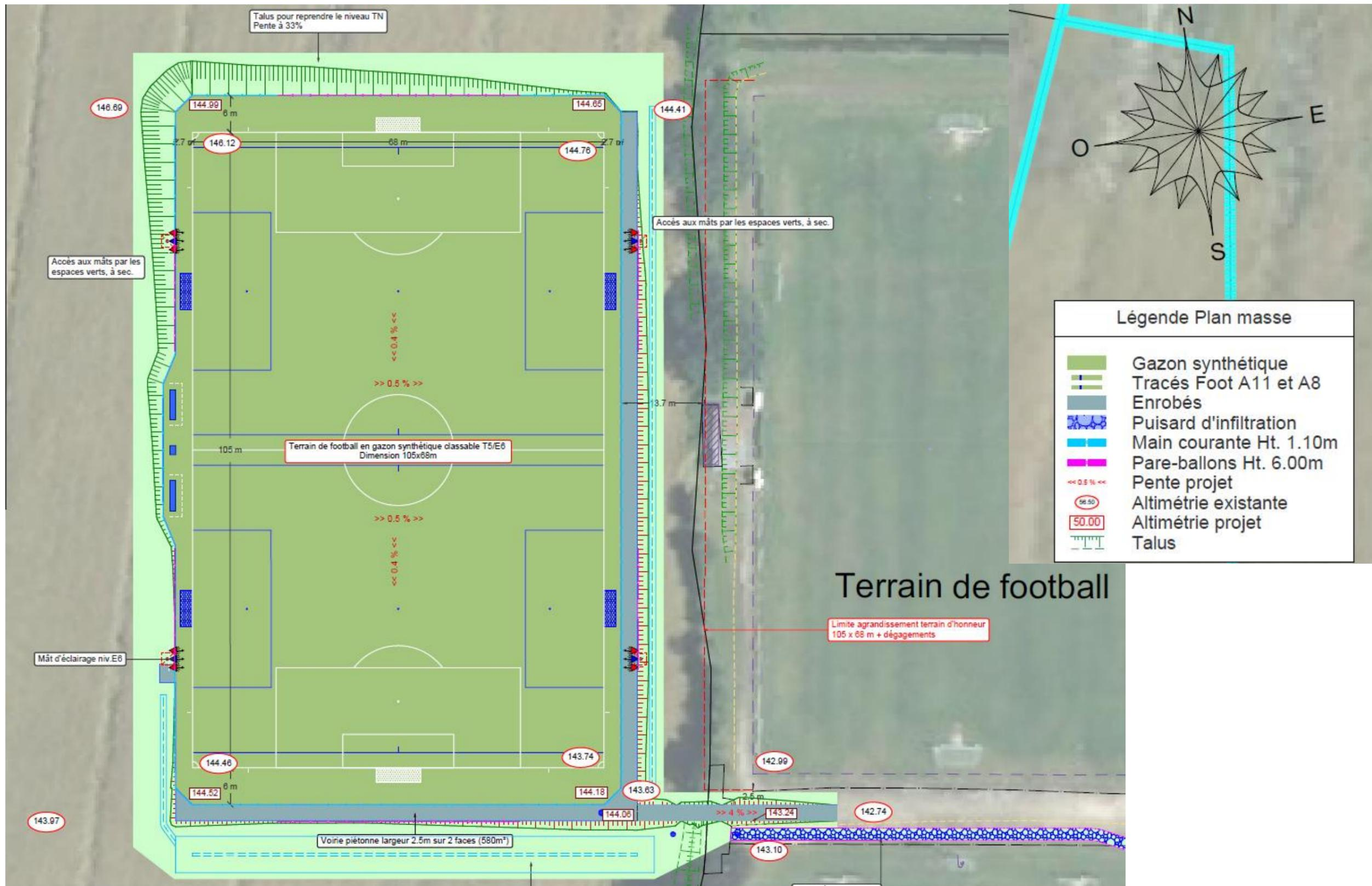
Figure 13 : Plan des terrassements du projet de terrain synthétique (Laval Agglomération)
